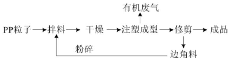
图 3-4 童车塑料制品生产工艺及产污流程
