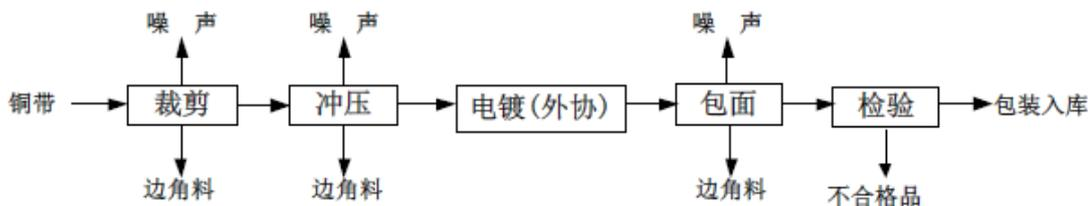
图 3-7 铜纽扣生产工艺流程图
