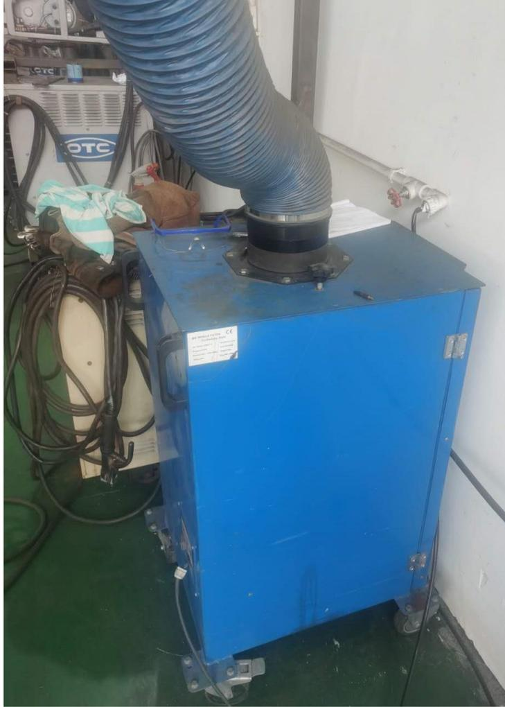
图 4-2 本项目有机废气治理设施图片
