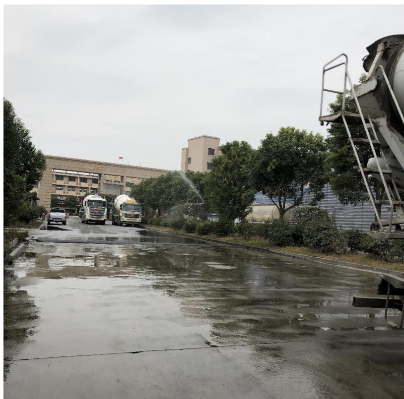
图4-5 地面降尘设施
