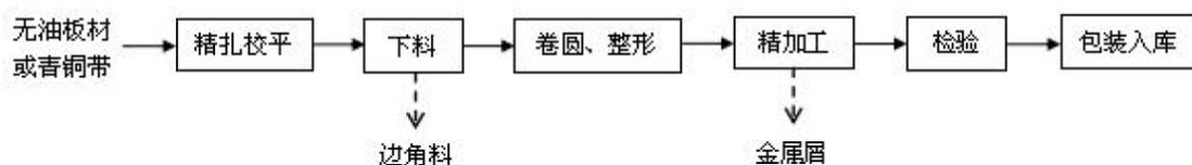
图 3-3 无油轴承生产工艺及产污流程
