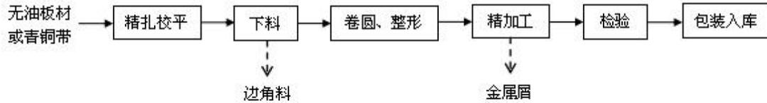
图3-2 无油轴承生产工艺流程图
