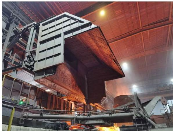
连铸机（改造后，已安装移动收尘罩）
