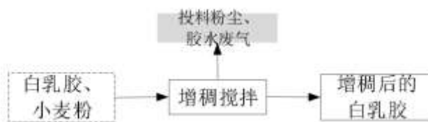
图 3-5 白乳胶增稠工艺流程图
