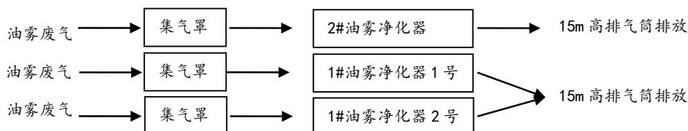
图 4-1 废气处理流程
