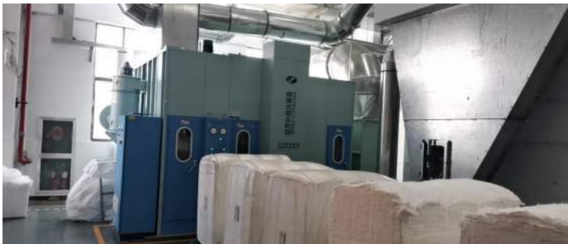
图 4-4 本项目开松和梳理工序粉尘治理设施图片
