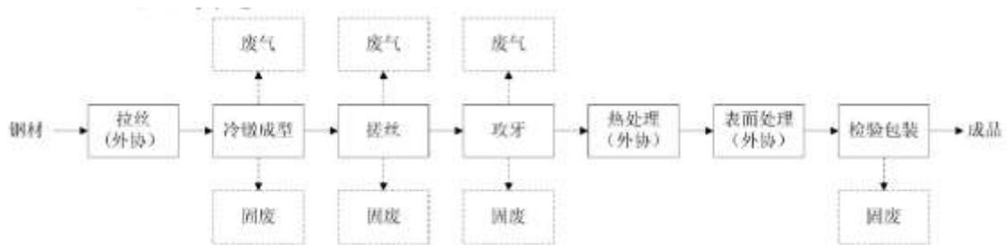
图 3-4 本项目生产工艺及产污流程图
