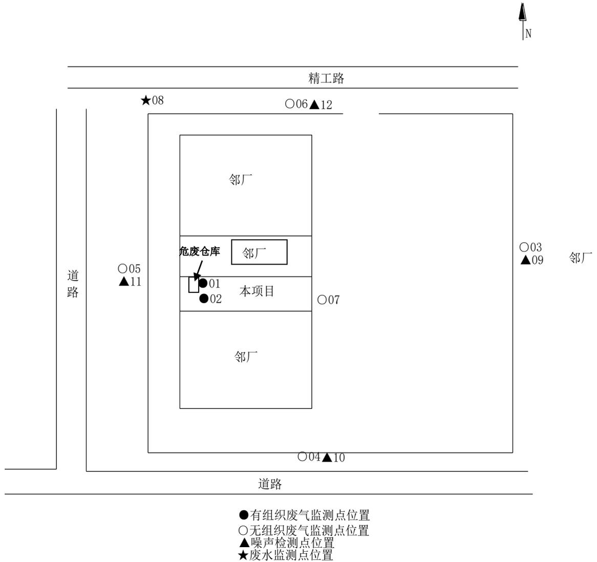
图 3-2 项目厂区总平面布置（监测点位）图
