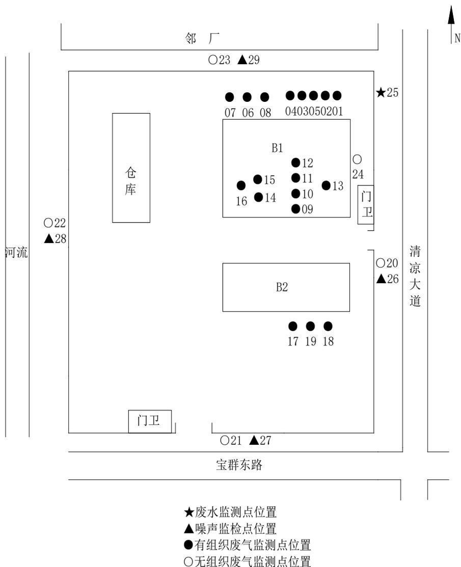
图 3-2 厂区平面布置图（监测点位图）
