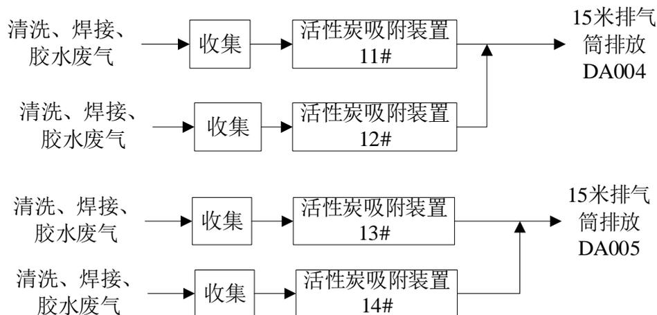
图 4-1 企业主要废气治理工艺流程
