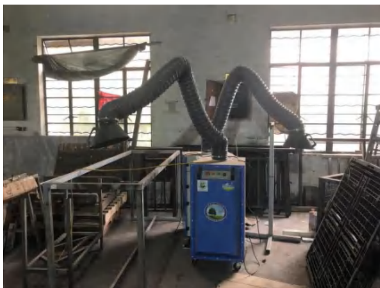
图 4-2 本项目移动式焊接烟尘净化装置图片
