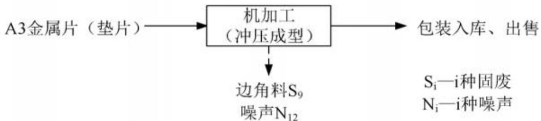
图 3-7 五金配件生产工艺及产污流程
