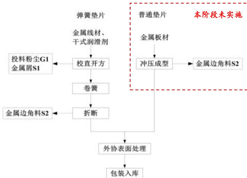
图 3-4 生产工艺及产污流程
