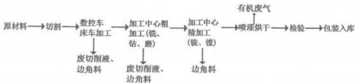
图 3-5 机床附件（刀架）生产工艺及产污流程
