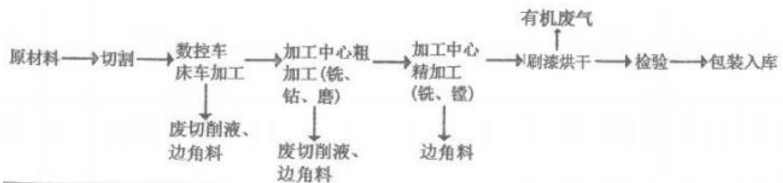
图 3-6 电梯马达机壳生产工艺及产污流程
