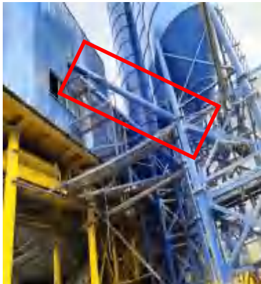
图 4-8 水泥螺旋输送机
