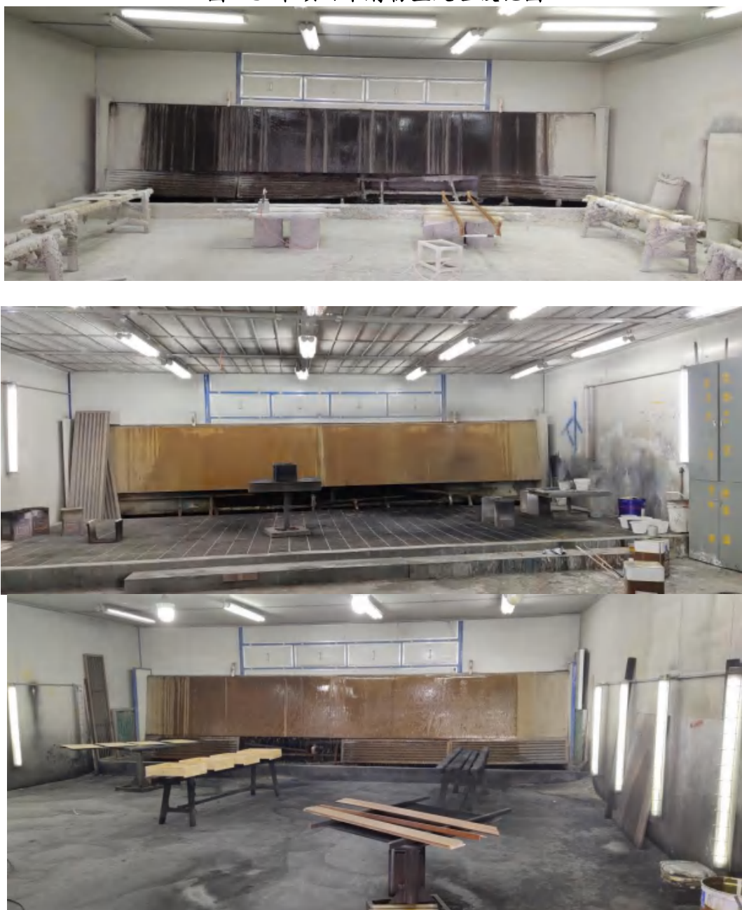
图 4-5 本项目木屑粉尘处理设施图
