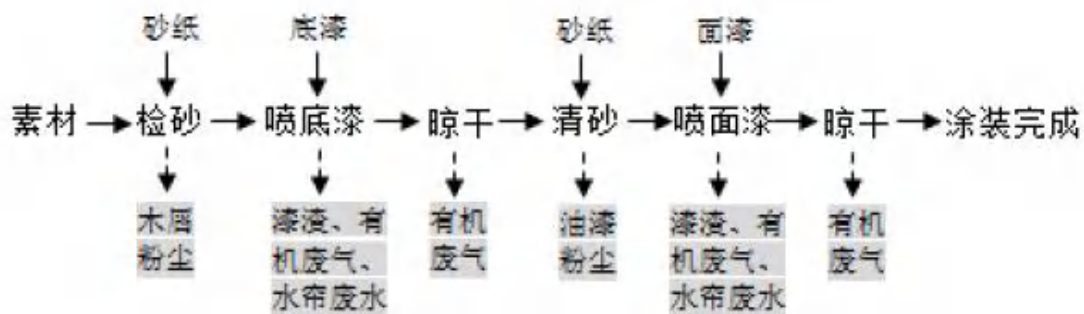
图 3-9 本项目板式家具、软体家具的木质框架的涂装工艺流程图
