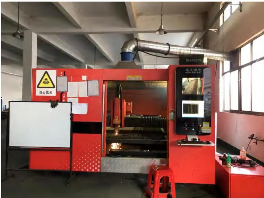
图4-2 激光切割废气处理设施图片
