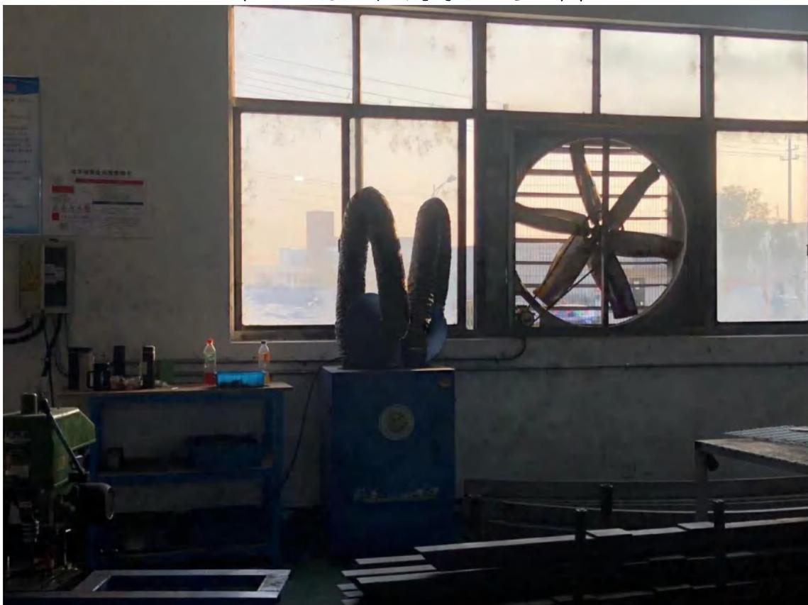
图4-5 焊接烟尘处理设施图片
