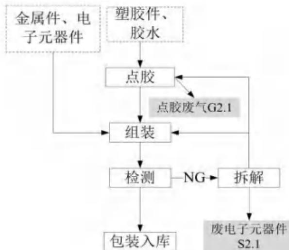
图 3-5 后盖模块生产工艺流程图
