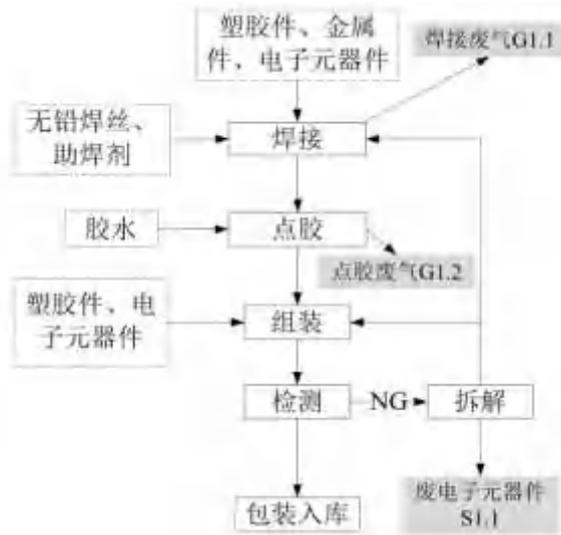
图 3-4 中框模块生产工艺流程图
