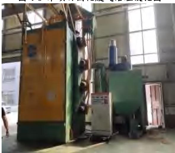
图 4-7 本项目抛丸废气治理设施图
