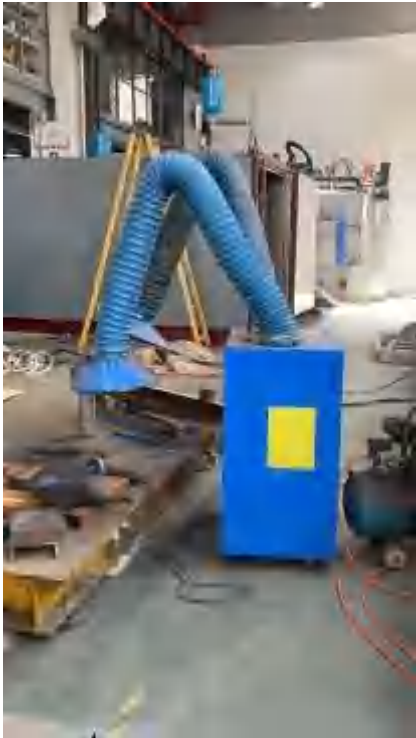
图 4-2 移动式焊烟净化装置图片
