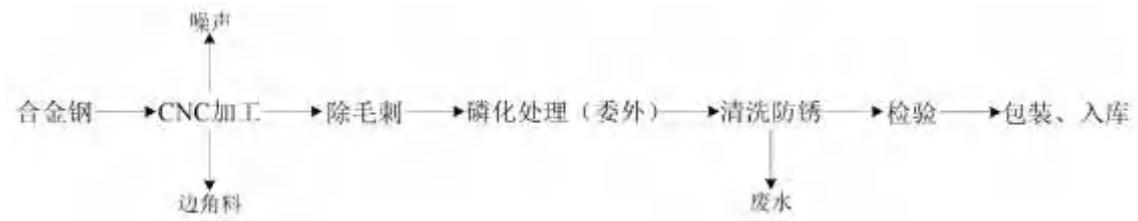
图 3-6 生产工艺流程图
