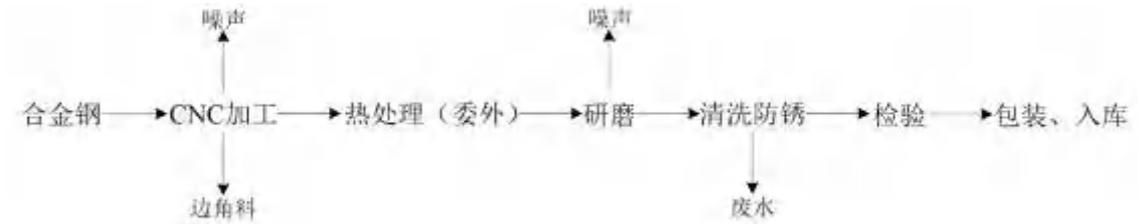
图 3-5 生产工艺流程图
