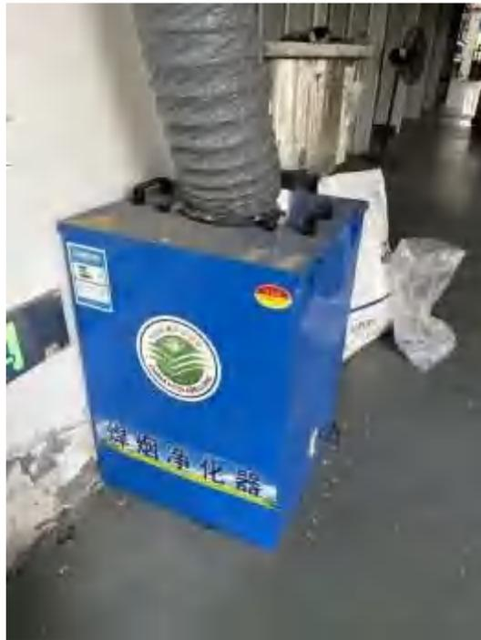
图 4-3 本项目除尘装置处理设施图片
