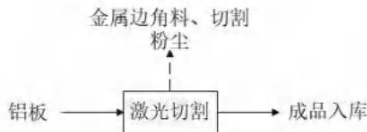
图 3-4 吸尘风机叶轮生产工艺及产污流程
