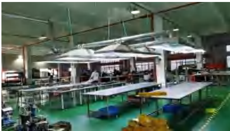
图 4-3 粘结废气收集设施图片
