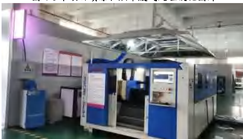
图 4-7 本项目激光切割废气处理设施图片
