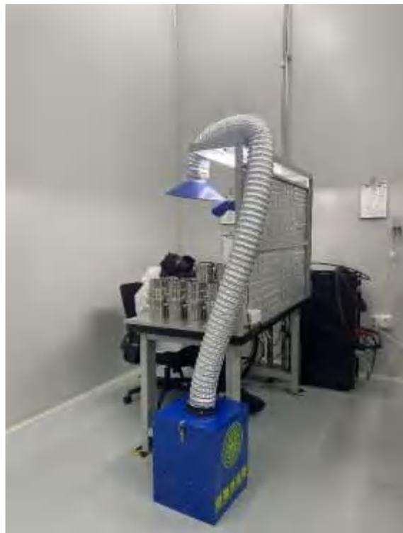
图 4-3 本项目焊接烟尘处理设施图片
