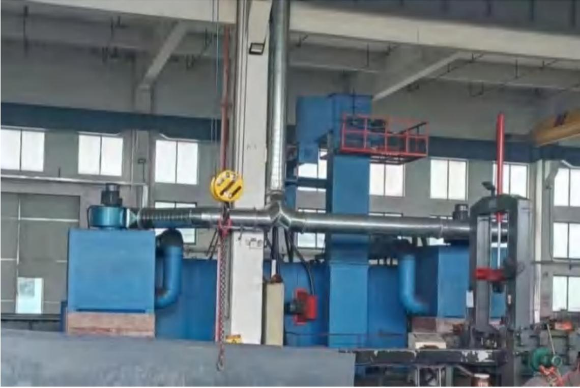
图 4-3 本项目抛丸粉尘自带废气治理设施
