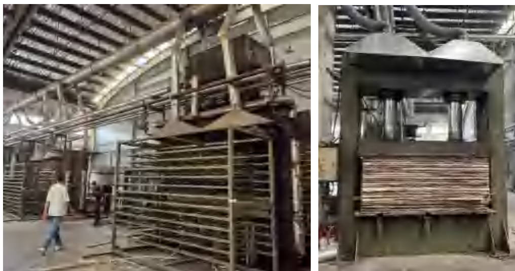
图 4-8 左图：热压废气收集设施、右图：冷压废气收集设施图片
