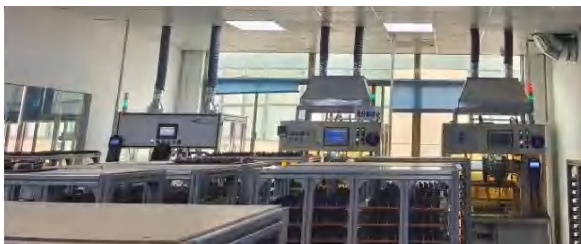
图 4-3 本项目灌封废气集气罩收集
