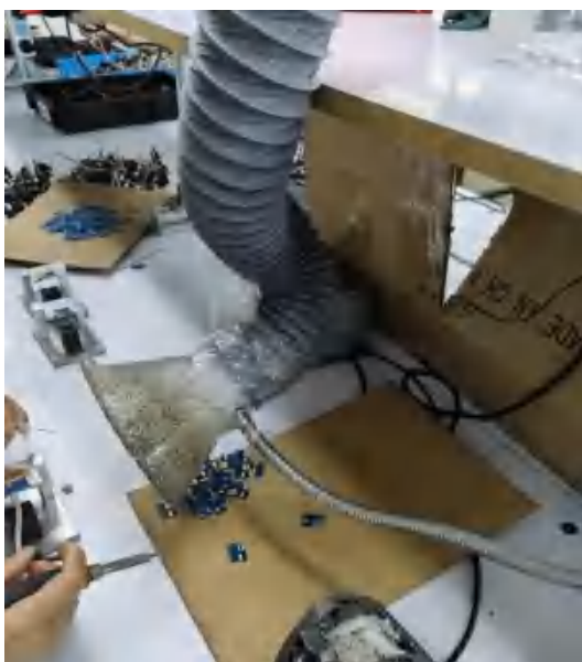
图 4-2 本项目焊锡废气集气罩收集
