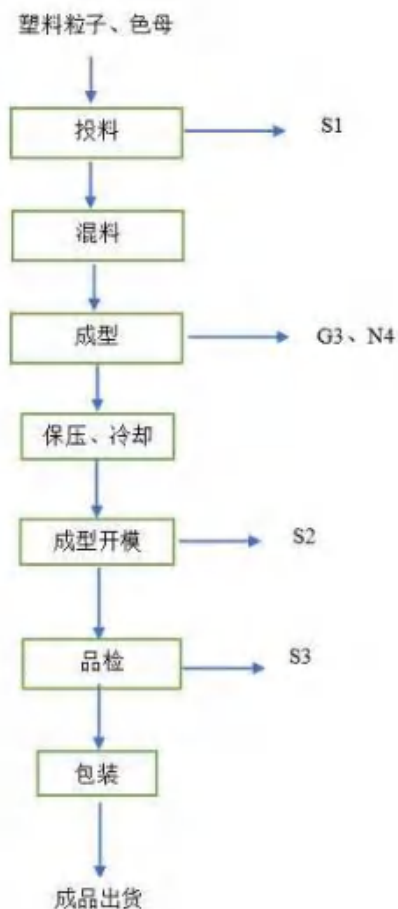
图 3-4 生产工艺及产污流程
